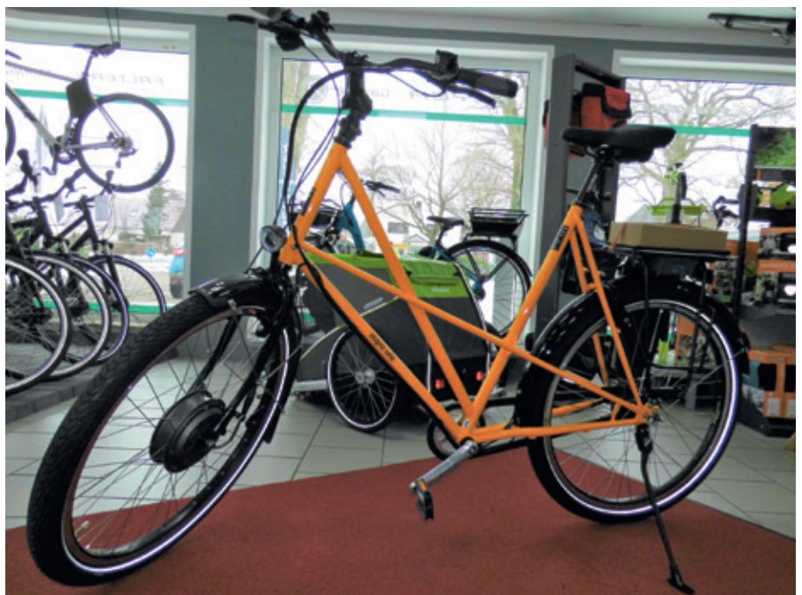
Dieser Kreuzrahmen sieht filigran aus, trägt aber hohes Gewicht.
